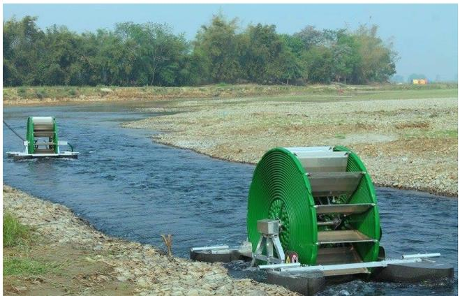
Esta bomba hidro-propulsada puede ser fácilmente instalada en cualquier lugar donde hay agua corriente cerca de los campos y requiere muy poco mantenimiento. La bomba puede utilizarse como una unidad autónoma para bombear agua al campo o puede combinarse con otras tecnologías complementarias como los sistemas de riego por goteo.
