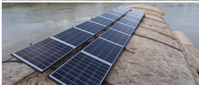
Los módulos fotovoltaicos se instalan en el techo del barco, proporcionando entre 200 Wp, 600 Wp y 1-2 kW de potencia, dependiendo de la demanda eléctrica. La iluminación en los barcos es alimentada por los módulos fotovoltaicos. La instalación y mantenimiento de los sistemas fotovoltaicos son asegurados por ingenieros y técnicos de Shidhulai.
